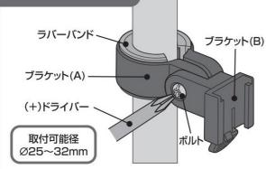
付属のラバーバンド(1mm、2.5mm)をシートポスト、または シートステーの径に合わせてブラケット(A)の内側にセット します。ブラケット(B)にボルトを通し、(+)ドライバーで ブラケット(A)にネジを締め込んで固定します。
